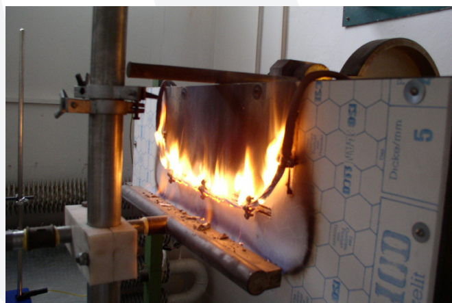
Obrázek zkušebního zařízení simulující vibrace při hoření zkoušeného kabelu
